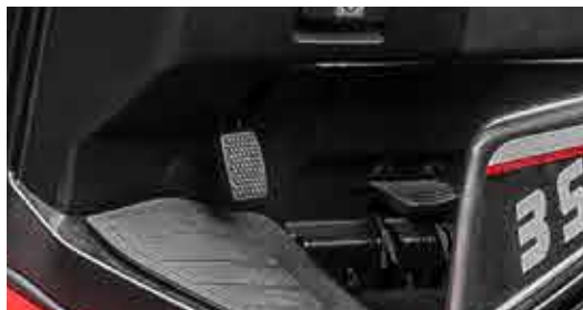
Pedalbediente Feststellbremse auf Wunsch
